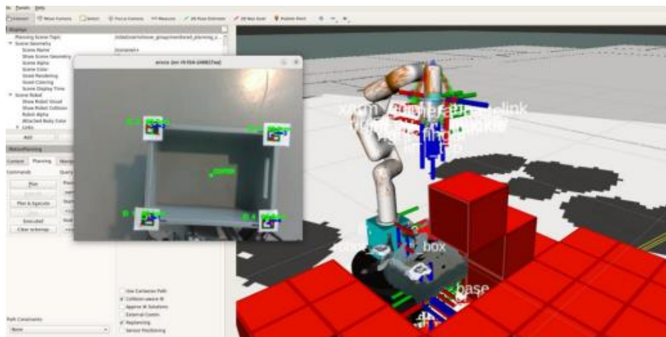
Figura 2. Representación del reconocimiento por parte de la cámara RealSense D435i de la posición actual de la caja
